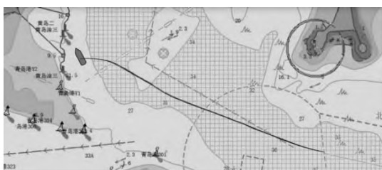
图7 重载船舶靠泊青岛港三期油码头电子海图轨迹 大型矿船由青岛董家口临时锚地起锚,最慢车速向北航道,航道航向为 318^\circ ,本船最慢车速 5\text{ kn} ,船舶所受阻力为 10^6\text{ N} 。
